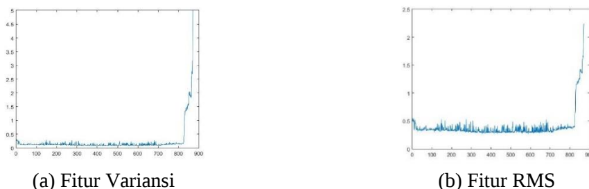
Gambar 1. Plot ekstraksi fitur variansi dan RMS vibrasi Bearing1_2 horizontal
