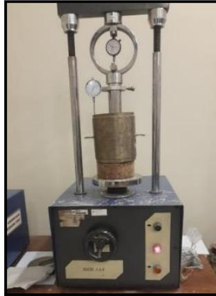
**Gambar 2.** Peralatan Pengujian CBR Laboratorium
