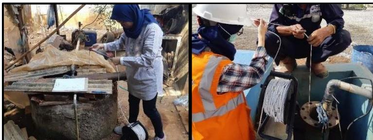
**Gambar 2.** Pengukuran Kedalaman MAT pada Sumur Gali dan Sumur Bor
