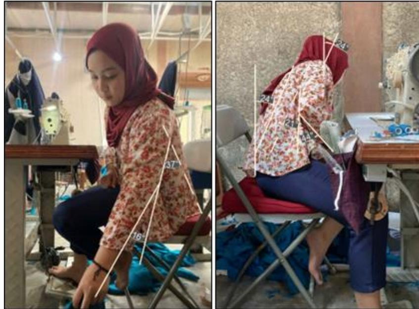
**Gambar 2.** Pengukuran Risiko Kerja Operator 1 (Elemen Kerja 1)
