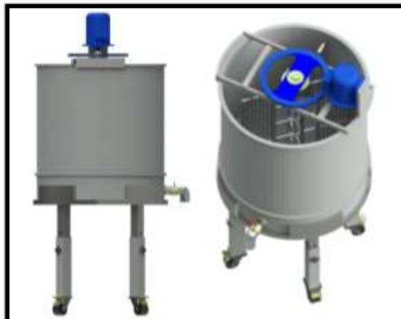
**Gambar 2.** Rancangan 3D Alat Pencucian Kedelai
