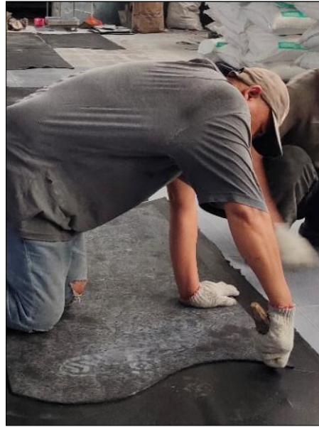
Gambar 4. Aktivitas Pemotongan Badan Karet
