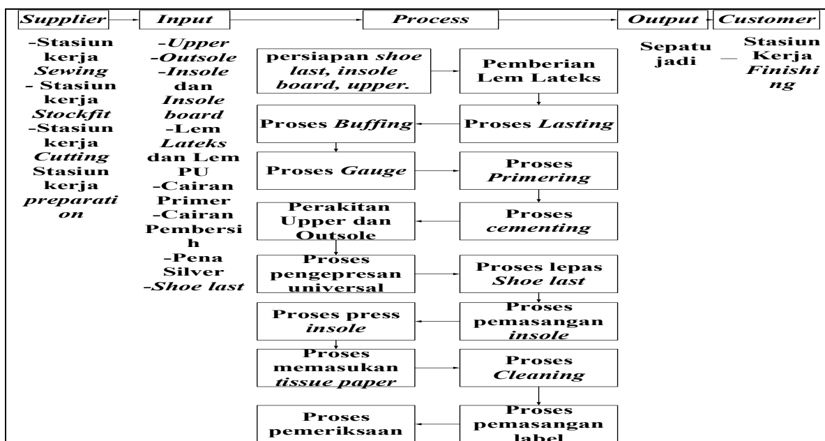
Gambar 2. Pemetaan Proses dengan Diagram SIPOC
