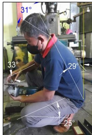
Gambar 7. Postur Kerja Set Up Akhir Mesin Gerinda Tangan
