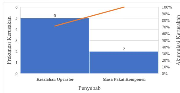
**Gambar 1.** Penyebab *breakdown* pada mesin *Sealing* CC
