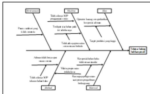
**Gambar 9.** *Fishbone diagram* tekstur bolong bahkan pecah
