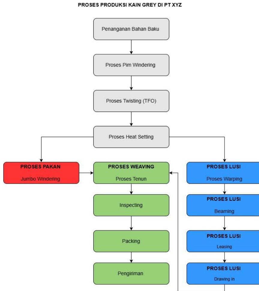
Gambar 2. Proses Produksi Kain Grey
